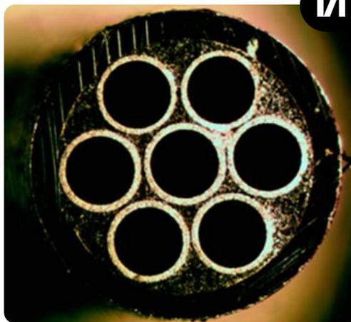
Предназначена для мониторинга радиально-осевых зазоров в компрессорах авиационных двигателей.
